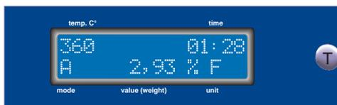
Probe einwiegen, Strahler darüber schwenken, Messung startet automatisch und endet bei Gewichtskonstanz.
