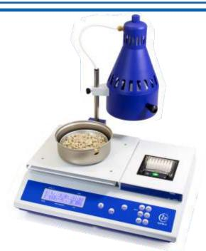
Nahezu 70 Jahre Erfahrung in Verbindung mit zeitgemäßer Technologie sind die Grundlage der ULTRA X Feuchtebestimmer. Präzisions-Wägetechnik, einfache Bedienung, gute Funktionalität, Design und robuste Bauart wurden praxisgerecht kombiniert.
