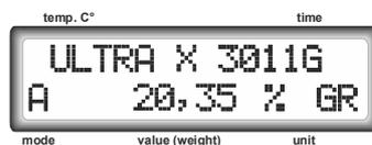
Mit können Sie zwischen Glührückstand (GR), Glühverlust (GV) und dem zuvor ermittelten Wert
