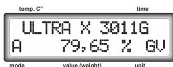
Nach Drücken der Taste wird das Gerät in den Wiegemodus zurückgesetzt. Ist ein eingebauter Drucker vorhanden, werden nun GR und GV ausgedruckt.
