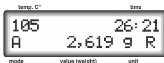
Durch Drücken der Taste , wird das Gewicht der getrockneten Probe (und der TS-Wert in %) gespeichert.
