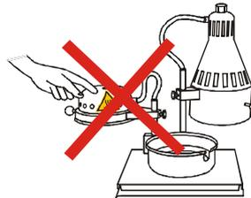
Vor Arbeiten am Gerät (z. B. Strahlerwechsel) Netzstecker ziehen!
